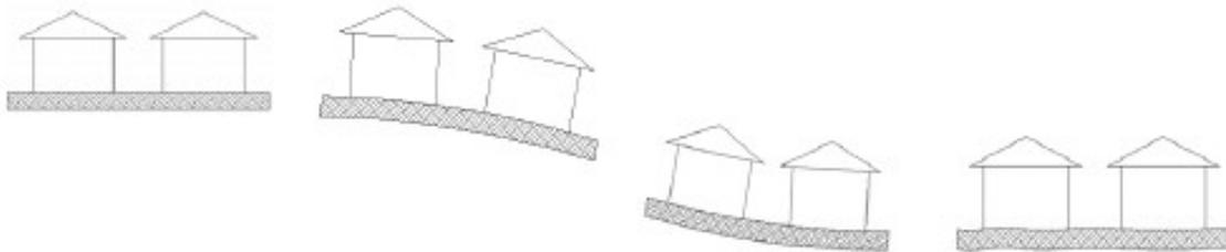
Une étude confiée en 2002 au Centre Scientifique et de Techniques du Bâtiment (C.S.T.B.) a mis en évidence le fait que les dommages subis par un bâtiment soumis à un affaissement minier pouvaient être importants pour des valeurs de pente faible (inférieure à 0,8 %), mais que le renforcement du bâti permet d'améliorer notablement leur comportement.
