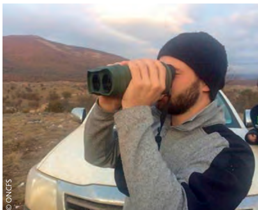
Détermination des distances de tir avec un télémètre
