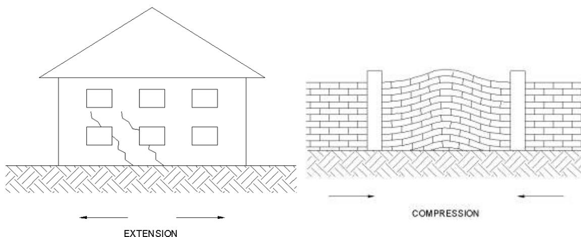
*Illustration des effets des déformations horizontales du sol sur le bâti*
